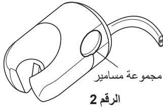
أصحاب الجهاز أسبسييس مصممة لمقاومة تلون الكيمايائية وأن تكون سهلة التنظيف. في وحدة التلقائي تشغيل الجهاز عند إزالتها من الحامل وداس على القرص مراقبة سيراً على الأقدام. في الجهاز اليدوي وحدة يتحقق الاختيار استخدام رمز التبديل محدد الجهاز. موافق أصحاب الجهاز الفردية قابلة للتعديل وترخي مسامير تعيين ونقل صاحب الصك إلى الموقع المطلوب وربيتائين المسامير. سوف تحتاج إلى مفتاح الهيكس 3 mm . انظر الشكل 2.
